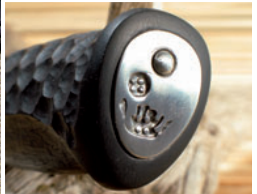
Ungewöhnliche Optik: Halbintegral aus C85-Carbonstahl mit einem Ebenholzgriff, der wie der integrierte Kropf und der Klingenträger mit einer wabenartigen Struktur versehen ist. Die Abschlussplatte mit dem eingestempelten Logo ist vernietet.
