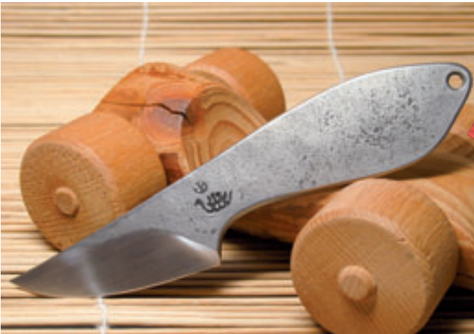
Schlicht, aber gut: Kompaktes Ganzstahlmesser aus 1.2842-Werkzeugstahl mit rustikaler Anmutung, aber feinem Finish an der Klinge.
