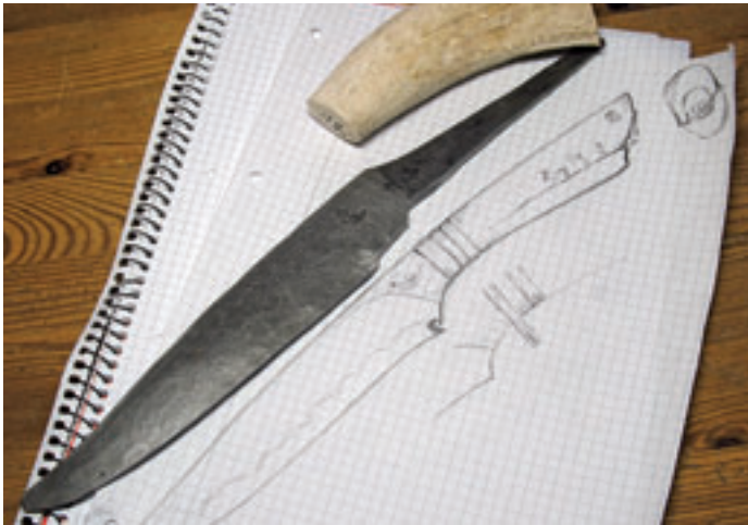
Zwischenschritt festgehalten: Gezeichneter Entwurf und Schmiederohling für einen Fighter aus C105.
